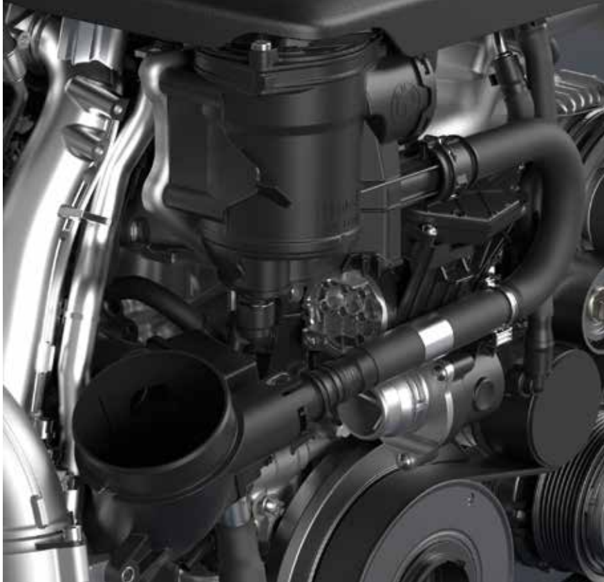
6 Az olajtól megtisztított kartergáz belépése a szívócsőbe
