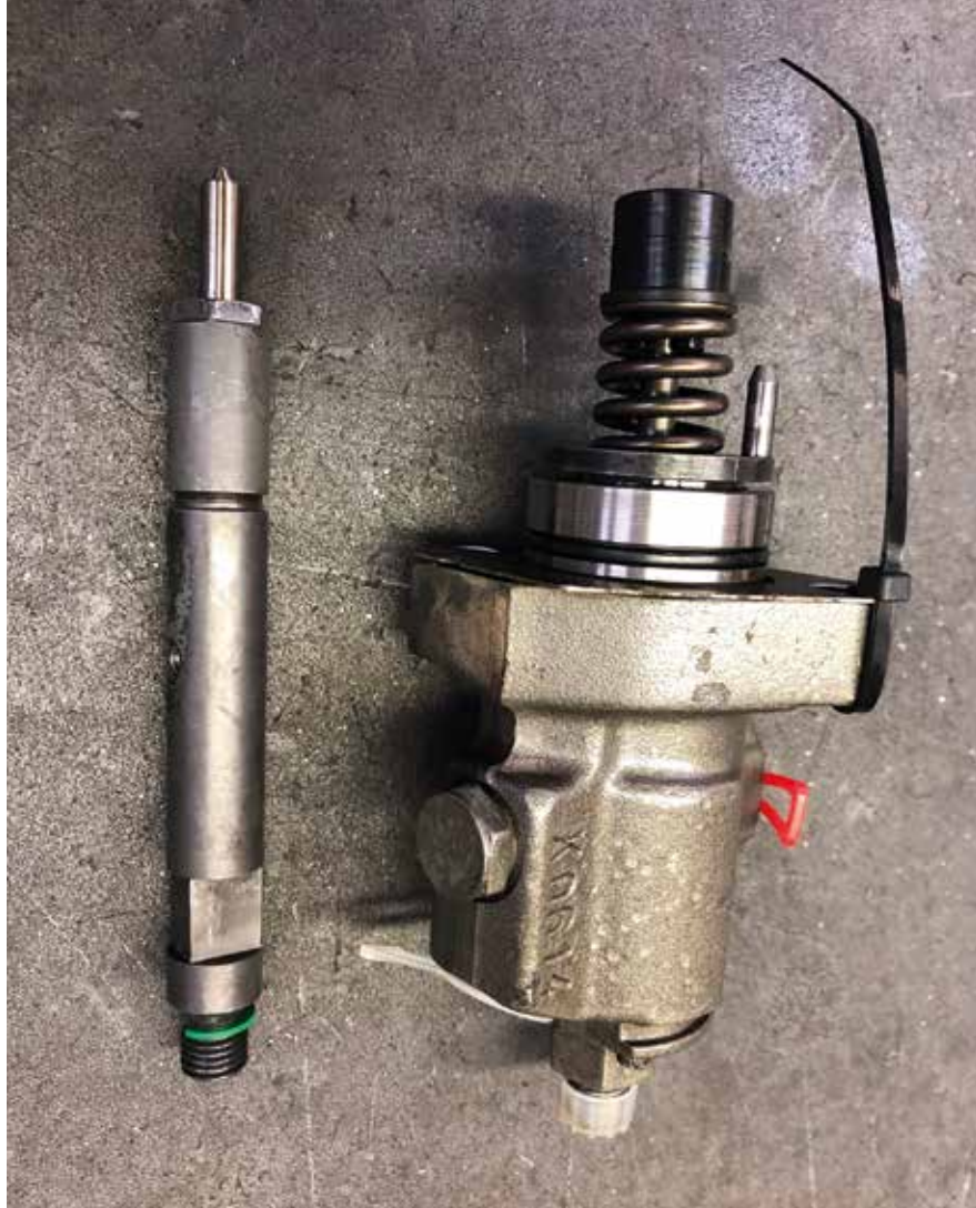
4 Deutz Einspritzpumpe Steckpumpe 04287047 F 4M 2011 CE44/1 (298-101 01-4-2-3)
