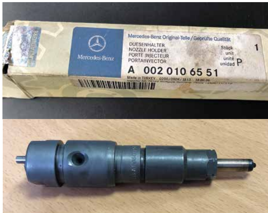
❶ Mercedes Actros, Járműazonosító: BP0770549; DHK STH azonosítója: Mercedes: 0020106551, 003 010 0651, 0060175721, 0060173021, Bosch 0432191242, Motor OM501/502LA
